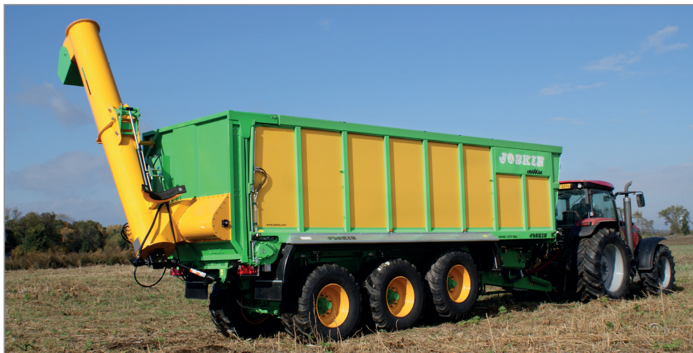
DRAKKAR mit Überladeschnecke und dynamischem Wiegesystem während der Entladung in einen Sattelaufleger um die gültigen Regelungen zu beachten.
